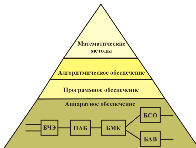
Рис. 1. Иерархия математического, алгоритмического, программного и аппаратного обеспечения ИММ
