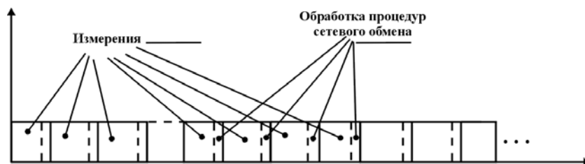
Рис. 6. Временная диаграмма функционирования одноядерного ИДД-1.0 при сетевом обмене пакетами данных в режиме разделения времени
