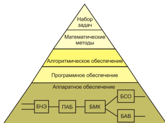
Рис. 1. Иерархия интеллектуального датчика давления
