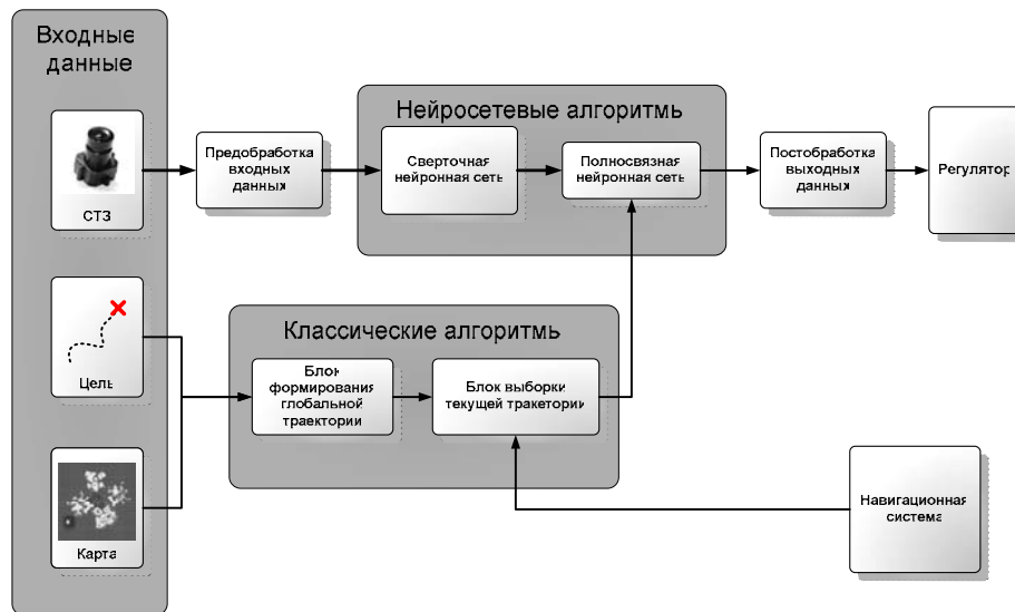
Рис. 1. Функциональная схема нейросетевого планировщика перемещений
