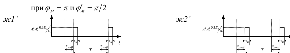
Рис. 15. Эпюры импульсов при детектировании на счетчиках фотонов при различных разностях фаз
