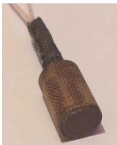
Рис. 1. Преобразователь с демпфером и с четвертьволновым слоем
