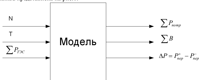
Рис.1. Общая схема модели для прогнозирования мощности нагрузки и межсистемного обмена и расхода топлива в энергосистеме
