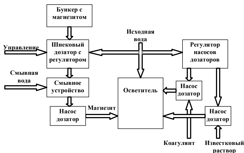
Рис. 3. Схема прерывистого автоматического регулирования дозирования реагентов
