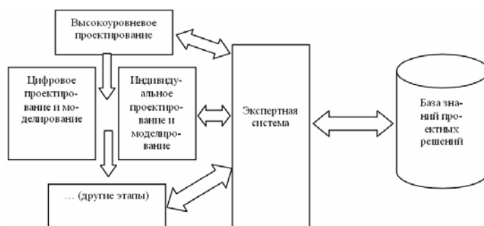
Рис. 1. Организация цикла проектирования электронного устройства и внедрение экспертной системы
