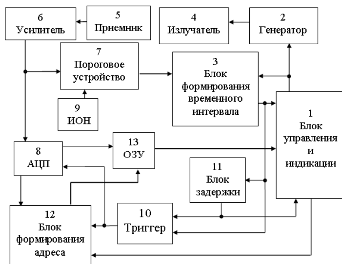
Рис.3. Структурная схема блока обработки ультразвукового расходомера
