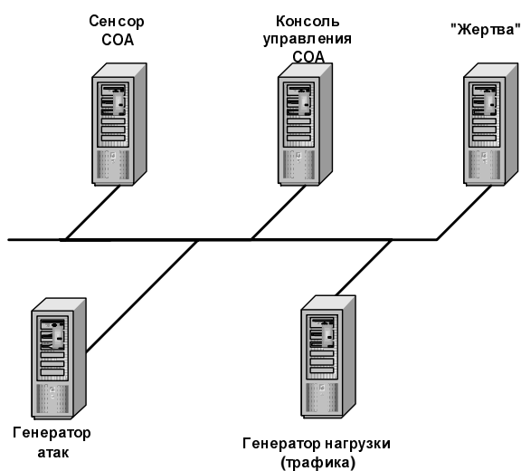
Рис. 2. Топология стенда для проведения тестов производительности
