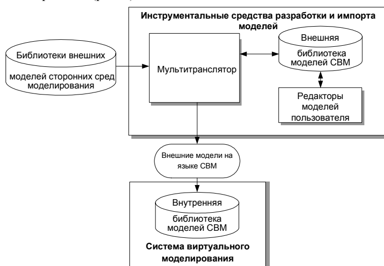
Рис. 4. Организация инструментальных средств разработки и импорта моделей подсистемой импорта на основе Мультитранслятора
