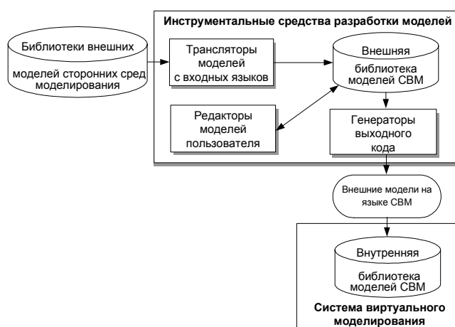
Рис. 2. Структура инструментальных средств разработки моделей
