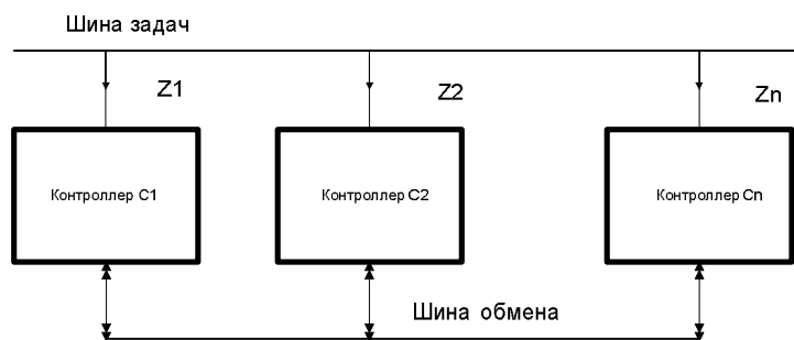
Рис. 1. Структура многоконтроллерной системы (компьютерной сети)
