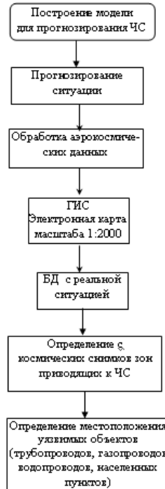
Рис. 2. Схема алгоритма прогнозирования чрезвычайной ситуации с применением ГИС-технологий
