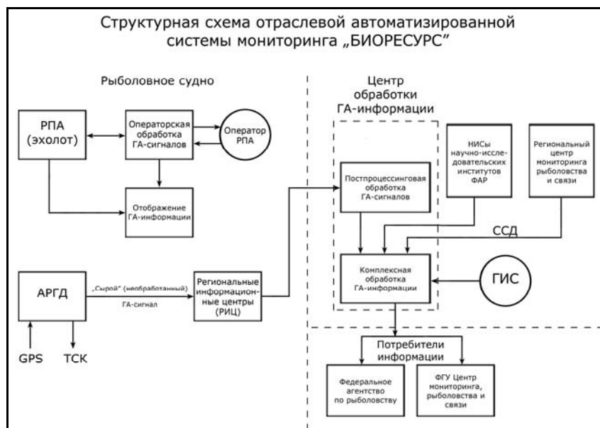
Рис. 1. Проект структурной схемы отраслевой автоматизированной системы «Биоресурс» с АРГД
