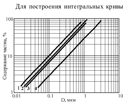
Рис. 2. Дисперсное распределение частиц сигаретного дыма: 1 – «Bond», D_m = 0,5 мкм; 2 – «Наша-марка», D_m = 0,65 мкм; 3 – «Marlboro», D_m = 0,75 мкм; 4 – «Махорка», D_m = 1,75 мкм
