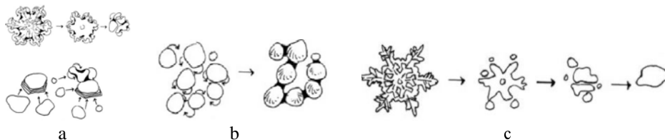
Рис. 4. Изменение свойств ФК снега под действием сублимации (а), спекания (b), округления (с)
