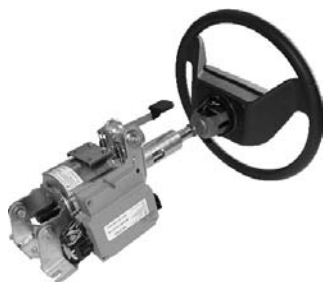
Рис. 1. Общий вид электроусилителя руля
