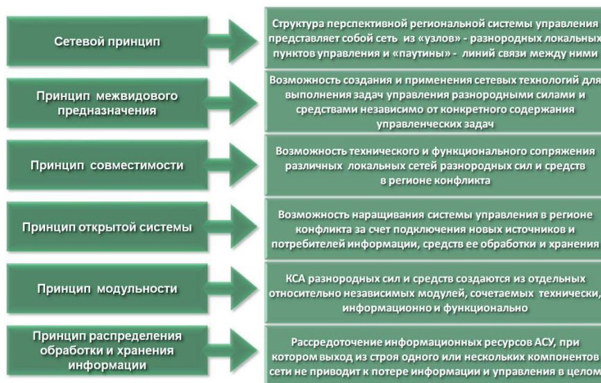
Рис. 1. Основные принципы построения сетецентрических систем управления
