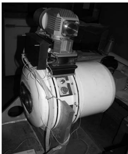
Рис. 2,а. Гиперспектрометр на основе динамического Фурье-спектрометра для определения малых газовых вредных примесей в атмосфере
