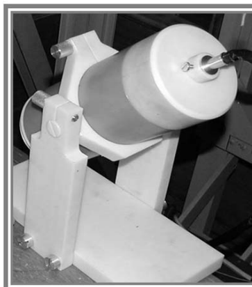
Рис. 7. Калиевый Мх-магнитометр с оптической накачкой, обладающий вариационной чувствительностью 0,0005 \text{ нТл} \cdot \text{с}^{1/2} и воспроизводимостью не хуже \pm 0,02 \text{ нТл} в диапазоне полей от 15 000 до 100 000 нТл
