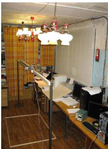
Рис. 3. Общий вид стенда для экспериментов и калибровки алгоритмов определения смещений камеры на основе оптического потока. Белой рамкой ограничена зона, в которую могут помещаться объекты, имеющие различную текстуру
