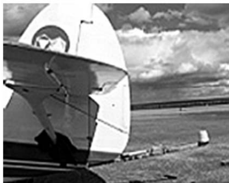
Рис. 1. Установка датчика магнитометра на борту самолета Ан-2
