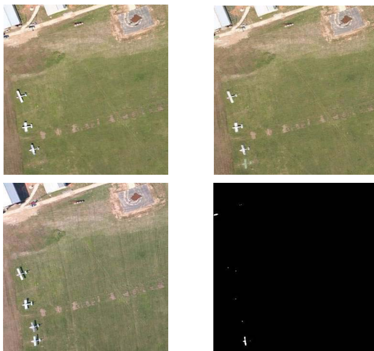
Рис. 4. Результат работы программы поиска изменений на паре кадров: исходные кадры, результат совмещения и нормировки, найденные изменения
