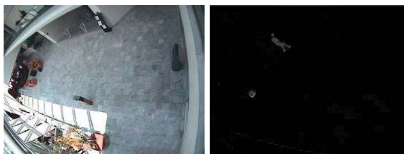
Рис. 5. Результат работы программы поиска оставленных вещей: выделяются оставленные вещи (опционально – движущиеся объекты)
