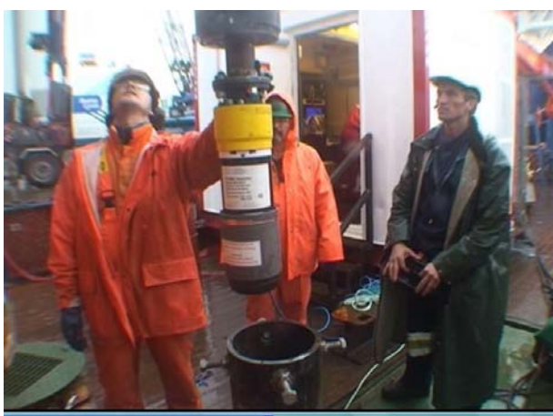
Рис. 2. Замена антенны навигационной системы USBL на борту судна "Мир". 2008 г.
