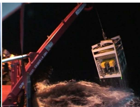
Рис. 5. Спуск ТПА в гараже типовым СПУ "П"-рама. Потенциально опасная ситуация
