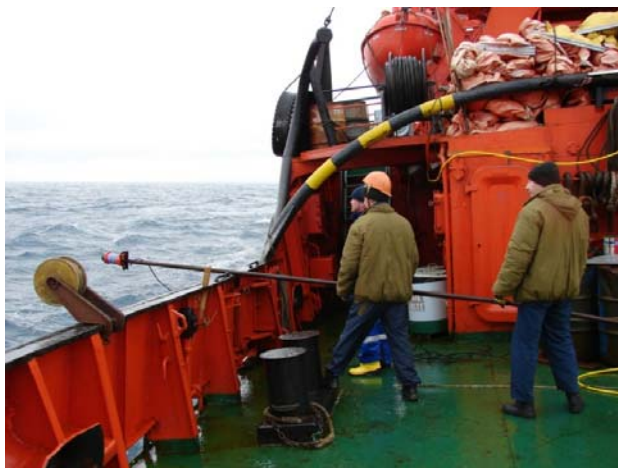
Рис. 1. Установка антенны навигационной системы USBL на борту спасательного буксира пр. 1454 «Калининградец». Баренцево море, 2006 г.
