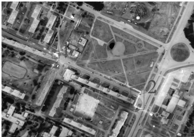
Рис. 1. Городская теплотрасса (Смоленская область, 2006 г): 1 – аварийный участок, 2 – участок с повышенным тепловыделением
