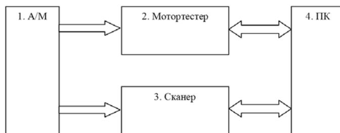
Рис. 2. Схема стенда для проведения эксперимента: 1 – а/м с датчиком давления в цилиндре, 2 – мотор-тестер Moto-Doc II, 3 – сканер ScanDoc, 4 – компьютер с ПО Quantex
