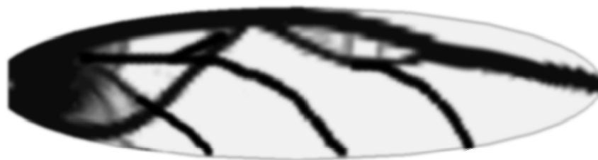
Рис. 6. Типичная картина распределения армирующих жилок на поверхности эллиптического в плане крыла – распределение функции \rho(\mathbf{x})
