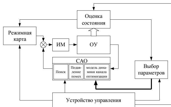
Рис. 1. Структура нечеткой адаптивной системы автоматической оптимизации
