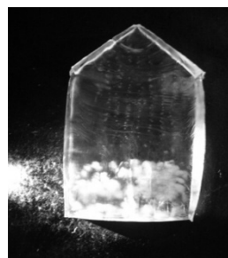
Рис. 5. Включения на расстоянии 250 мм от заправки
