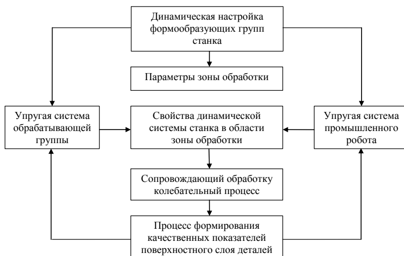
Рис. 1. Схема динамического мониторинга роботизированного металлорежущего станка
