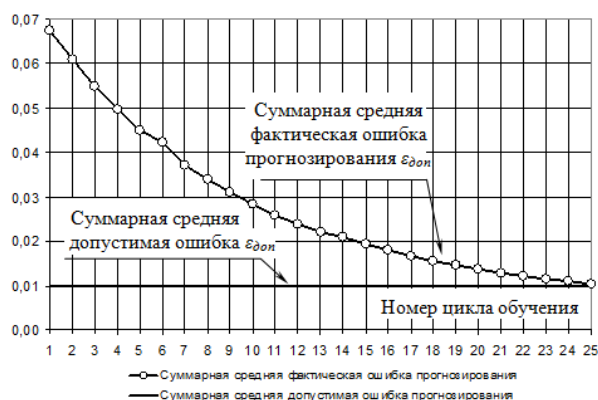
Рис. 7. Снижение суммарной средней фактической ошибки прогнозирования ЭС АД в процессе обучения ННС
