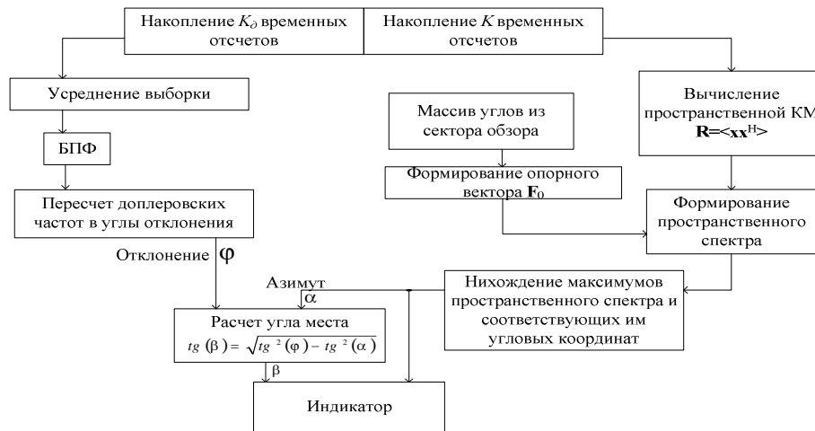
Рис. 7. Пространственно-доплеровский алгоритм совместного определения азимутальной и угломестной координат препятствий
