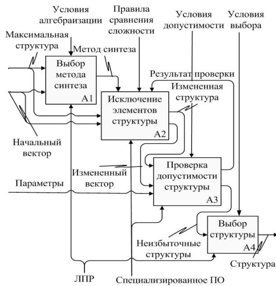
Рис. 2. Функциональная модель обработки информации при синтезе избыточных структур
