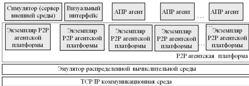
Рис. 2. Архитектура и компоненты инфраструктуры для поддержки командной работы автономных агентов
