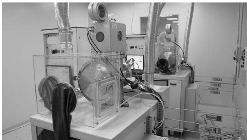
Рис. 2. Гермозона НОЦ «Нанотехнологии» ЮФУ с комплексом планарного технологического оборудования, сконфигурированного под задачи СВЧ-микроэлектроники и МЭМС
