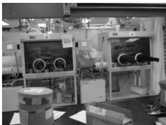
Рис. 3. Исследовательская линия для изготовления органических светоизлучающих экранов (OLED) в инертной среде университета Аризоны
