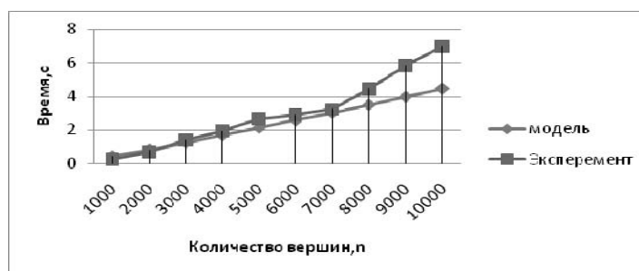
Рис. 5. Графики экспериментально установленного времени работы параллельного алгоритма Прима и теоретической оценки в зависимости от количества вершин в модели при использовании 2 процессоров
