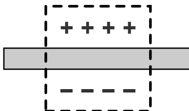
Рис. 3. Разностный шаблон большого размера, «пропускающий» тонкую линию
