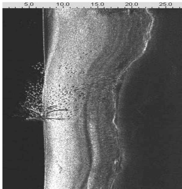
Рис. 1. Акустическое изображение дна с затопленным деревом и «стайкой» рыб
