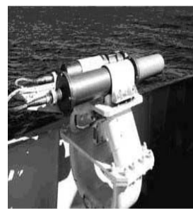
Рис. 4. Комплекс контроля поверхностного слоя воды
