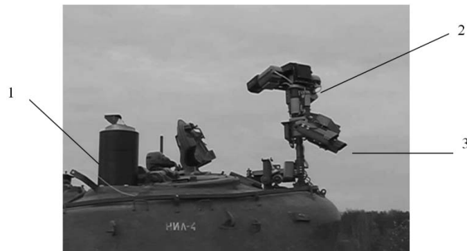
Рис. 4. Размещение средств видеонаблюдения на объекте управления: 1 – обзорно-поисковая СТЗ; 2, – система дневного и ночного видения; 3 – система стеровидения.
