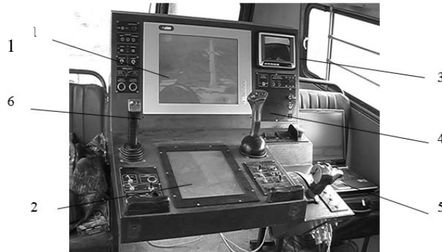
Рис. 3. Общий вид пульта дистанционного управления: 1, 2, 3 – мониторы СТЗ управления движением и оружием, отображения местоположения объекта управления на электронно-цифровой карте и камеры кругового обзора пульта управления соответственно; 4, 5, 6 – многофункциональные рукоятки управления движением (или оружием), переключения скоростей и камеры кругового обзора пульта управления соответственно
