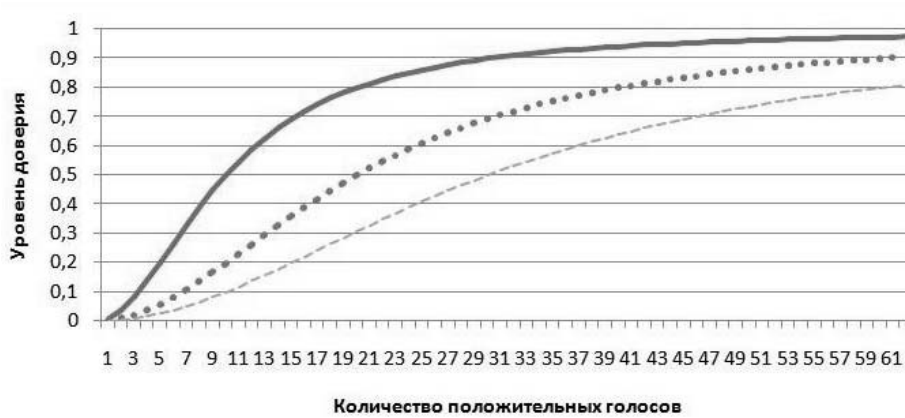
Рис. 1. (\varepsilon; \theta) -доверительная модель объекта, влияние параметра \varepsilon (сплошная линия – \varepsilon=10 , точка – \varepsilon= 20 , пунктир – \varepsilon= 30 )
