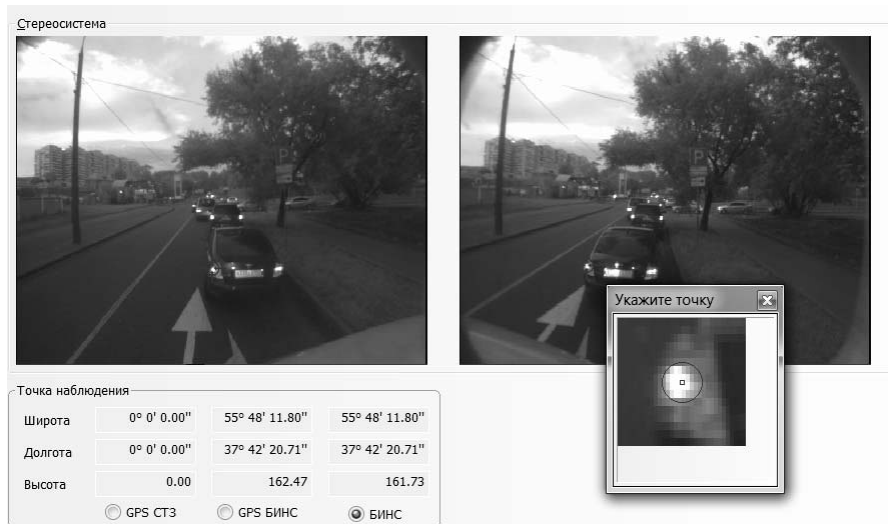
Рис. 2. Пример выделения характерных точек на образах объектов интереса. В левом поле зрения образ выделен автоматически, в правом уточнение местоположения выполняется с участием оператора
