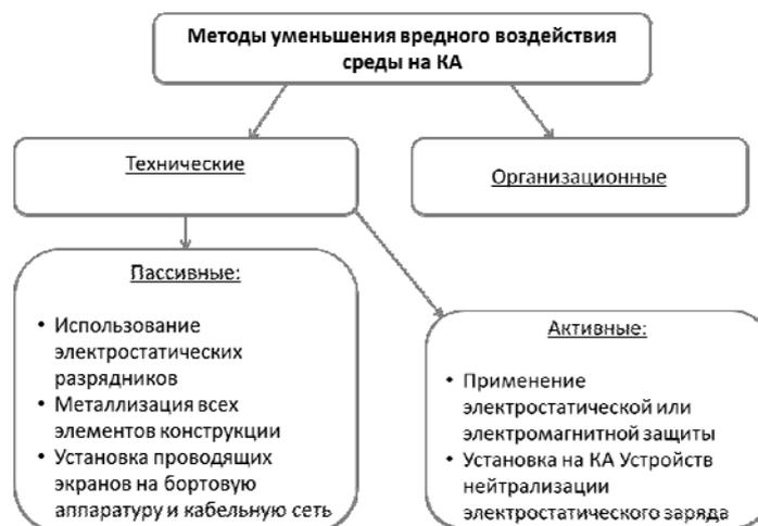
Рис. 3. Методы защиты КА от последствий электростатического заряда
