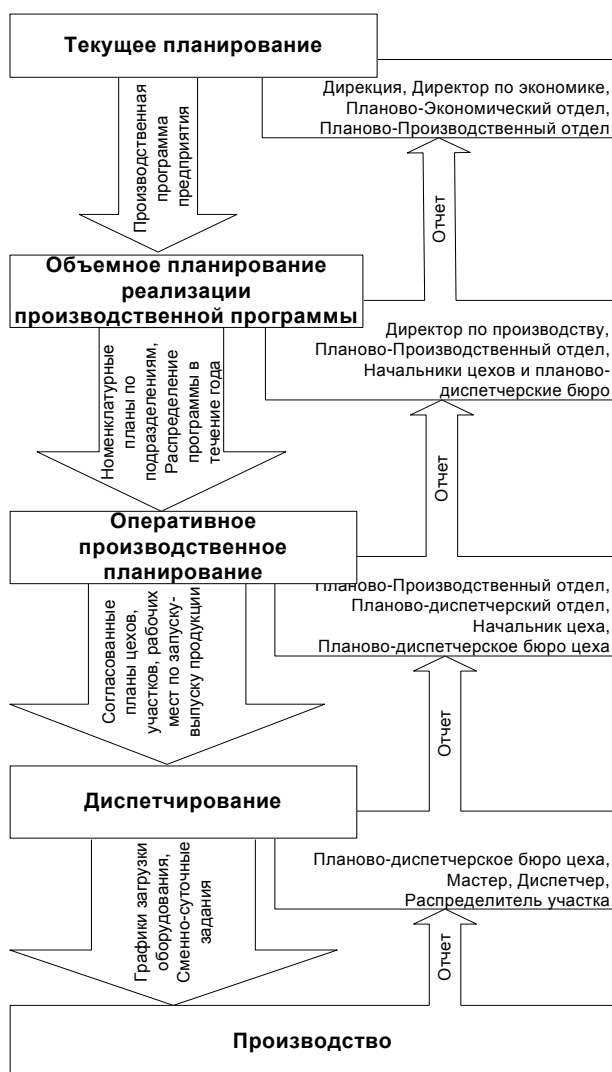
Рис. 1. Иерархия задач производственного планирования
