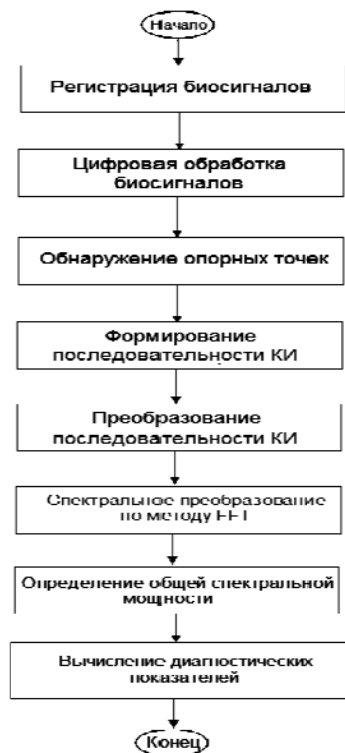
Рис. 1. Блок-схема диагностического алгоритма обработки биосигналов сердечного ритма с целью диагностики состояния коронарных артерий
