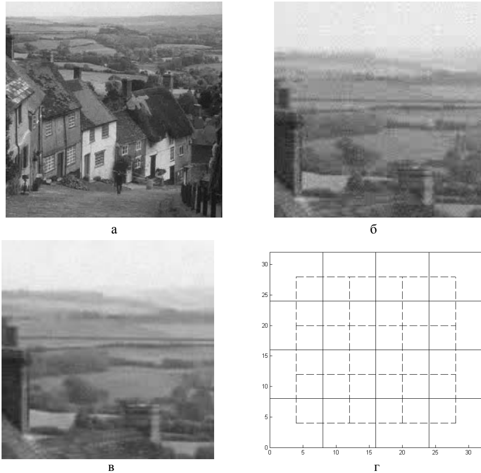
Рис. 1. Тестовое изображение Goldhill, искаженное аддитивным белым гауссовым шумом с дисперсией \sigma^2 = 100 (а), фрагмент этого изображения после ДКП-фильтрации без перекрытия блоков (б) и с частичным перекрытием (в), иллюстрация частичного перекрытия блоков (г)
