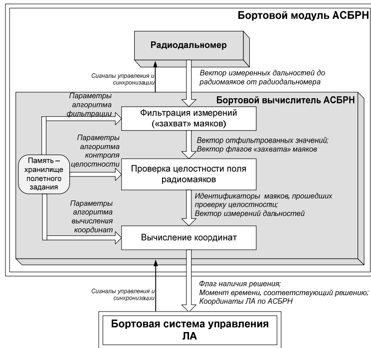
Рис. 1. Схема потоков данных при обработке информации в бортовом модуле АСБРН
