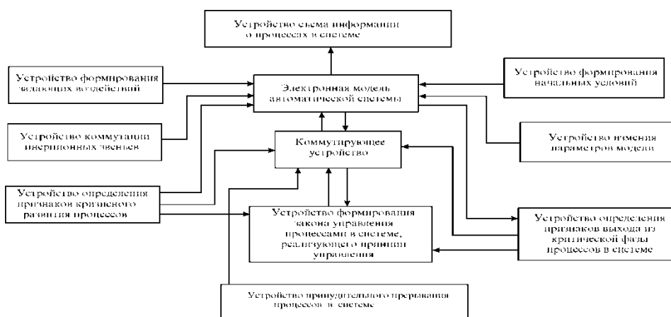
Рис. 1. Структурная схема моделирующего стенда
