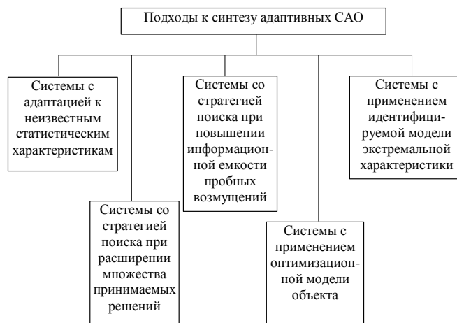
Рис. 1. Методы синтеза адаптивных САО с применением последовательных процедур статистической проверки гипотез
