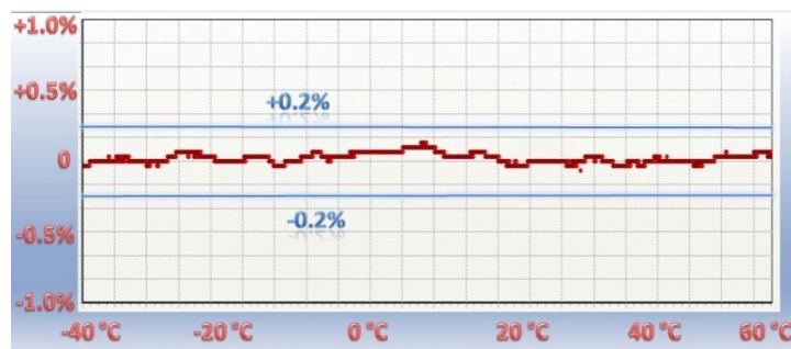
Рис. 12. Стабильность выходного сигнала в диапазоне температур от -40^{\circ}\text{C} до +60^{\circ}\text{C}
